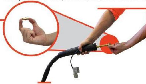
Наконечник заворачивается до упора и затягивается с небольшим усилием.
